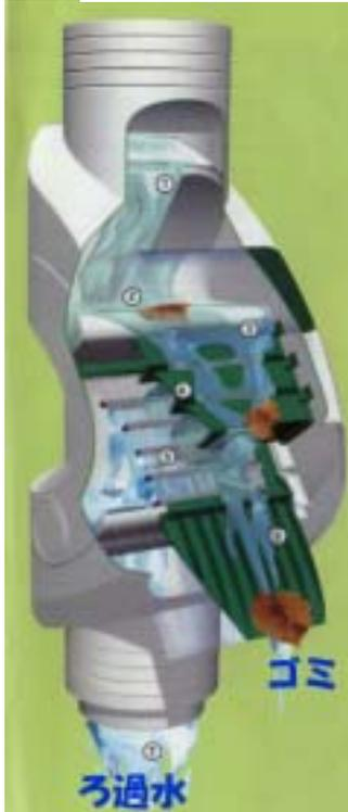
ライナスフィルターがユニークなのは、従来の雨水ろ過装置とことなり、ろ可水を下に落として、ゴミは地上に排出します。内部のフィルターは、2段構造になっており、ぱっぱ等の大きなゴミは、緑色の第1段部分で、そしてより微細なゴミは0.55mm間隔の2段目のステンレスフィルターで分離されます。
