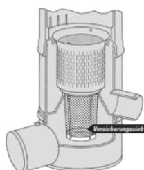
ドレイン(排水)が浸透式の排水管などの場合、目詰まりを防ぐ目的で使用します。
