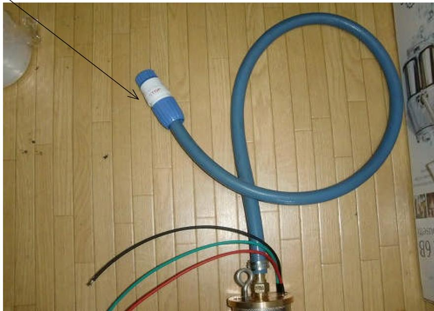
ビニールホース、ポリエチレンチューブを使用し、引き上げ安くすることが大切です。塩ビ管等で固定しまうと清掃が面倒です。
