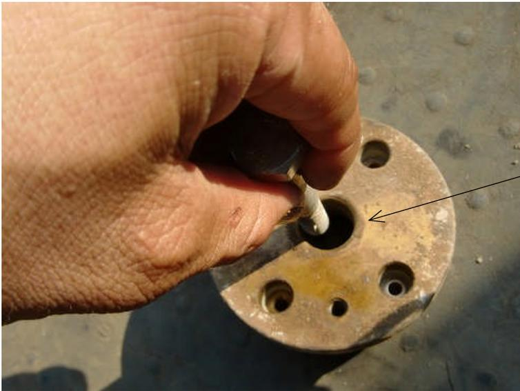
棒状のものをグッと押し込むと弁がはずれます。
