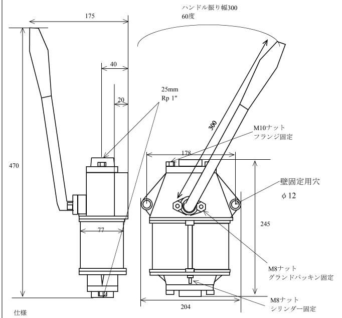
シリンダー内径76mm、シリンダー 2 セット、接続配管25ミリ、吸い上げ能力 7 m(フート弁使用時、未使用時は3 mまで)、押し上げ約能力  $15 \, \text{m}$ 、重量  $3 \, \text{Kg}$ 、揚水能力 $40 \, \text{l/min}$ 、用途、きれいな水。燃料輸送用に使う場合はパッキンの素材交換で対応可能できます。
