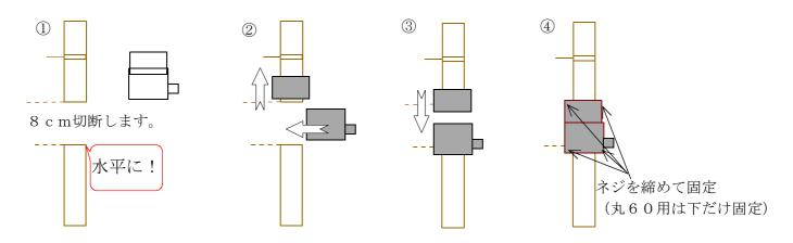
①トイを8cm切断します。②上フタを挿入し上にずらし、本体を差込ます。③上フタを下にずらします。本体側面にあるネジを手でしめてトイに固定して完了です。
