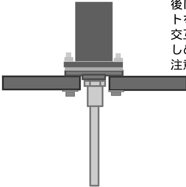
後はポンプをのせて、4箇所のボルトをスパナーでしめます。4箇所を交互にしめていきます。1箇所だけしめすぎるとポンプが割れますので注意してください。
